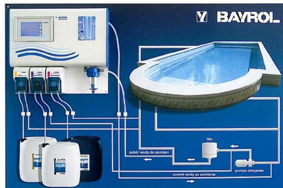
Podłączenie PoolManagera tlenu
